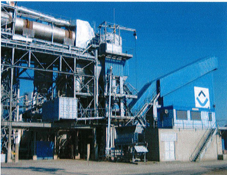
Asfaltfabriek Roermond met op de voorgrond de doseur, waar na enkele proef- en demovakken asfaltbeton wordt geproduceerd met de optie om granulaat (van dakbedekking) toe te voegen.
