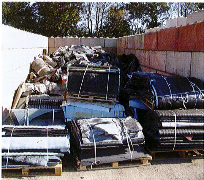
Oud dakbedekkingsmateriaal ligt gereed om tot granulaat te bewerken
